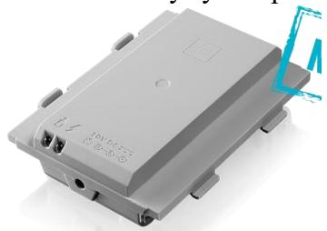
Литий-ионная аккумуляторная батарея постоянного тока EV3 имеет емкость 2050 мАч и специально создана для работы с новыми микрокомпьютерами EV3.
